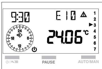
⚠ Se dopo un arresto di sicurezza, la caldaia effettua la fase di accensione e riprende il regolare funzionamento, l'arresto è riconducibile ad una situazione casuale. Il ripetersi di blocchi suggerisce l'intervento del Centro di Assistenza Tecnica.
