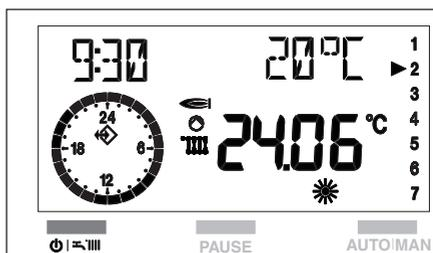
La caldaia effettuerà la fase di avviamento e resterà in funzione fino a quando saranno raggiunte le temperature impostate.
