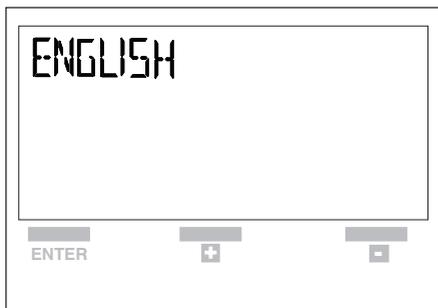
All'apertura del coperchio, solo dopo ogni interruzione di alimentazione elettrica del pannello di controllo remoto, viene visualizzata la lingua impostata.
