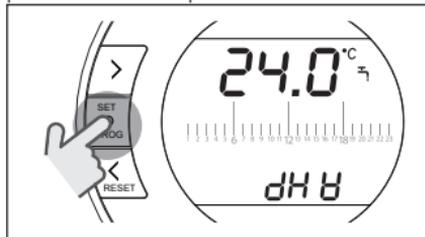
Premere il tasto UP  $\wedge$  o DOWN  $\vee$  per modificare la temperatura di setpoint sanitario.
